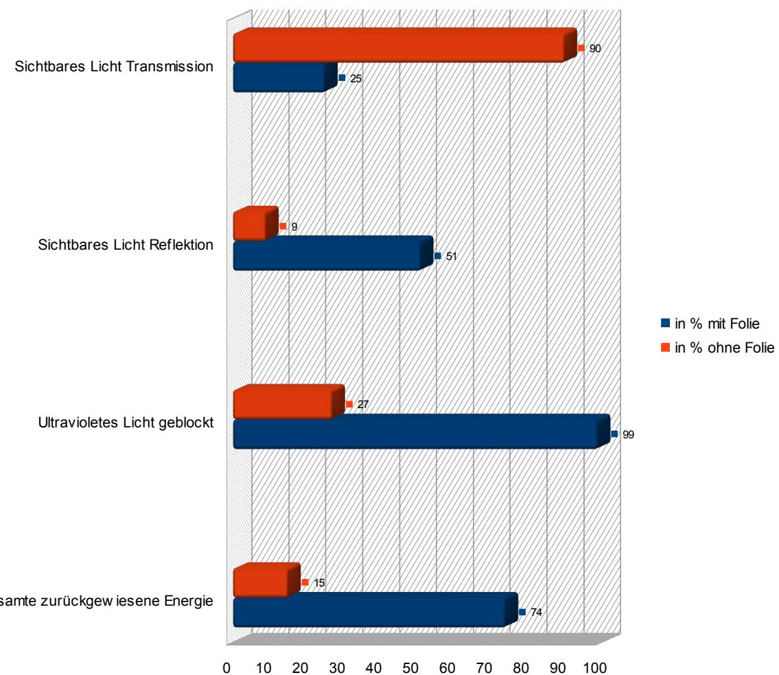
Ergebnisse basieren auf einer 4mm dicken Isolierglasscheibe.
