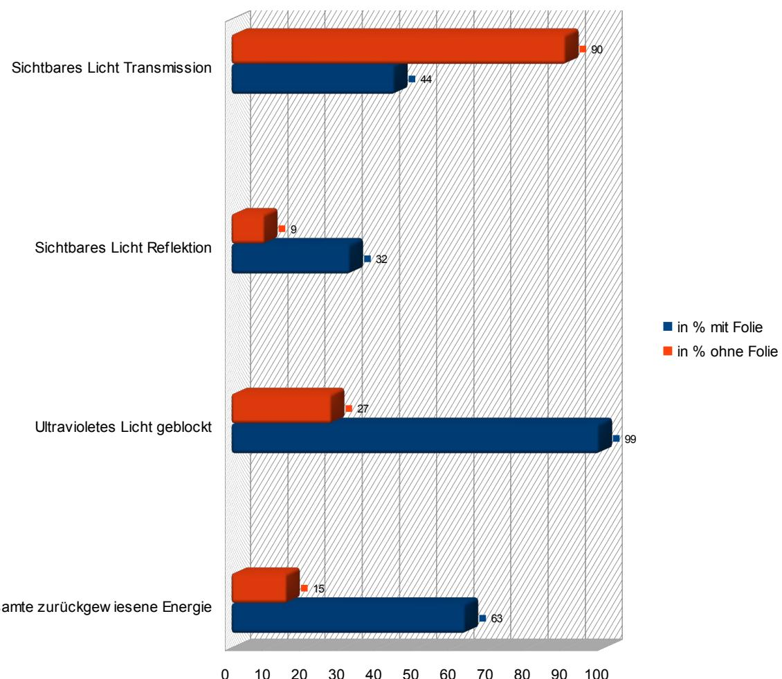
Ergebnisse basieren auf einer 4mm dicken Isolierglasscheibe.
